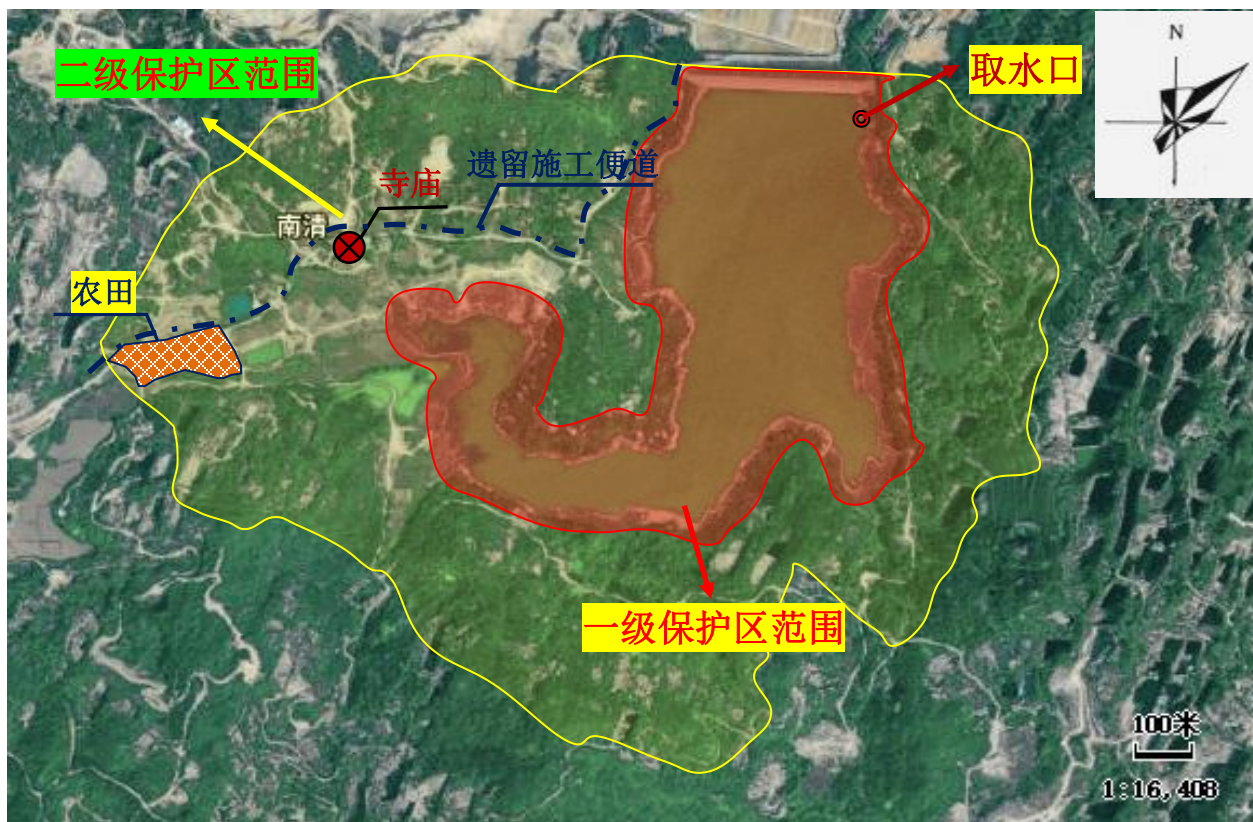
附图 5 苏内水库饮用水源保护区范围内风险源分布示意图
